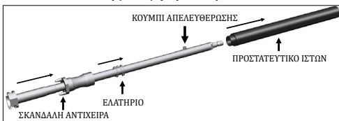
Εικόνα 1: Αποσυναρμολόγηση του προστατευτικού ιστών
