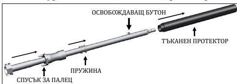
Фигура 1: Сваляне на тъканен протектор
